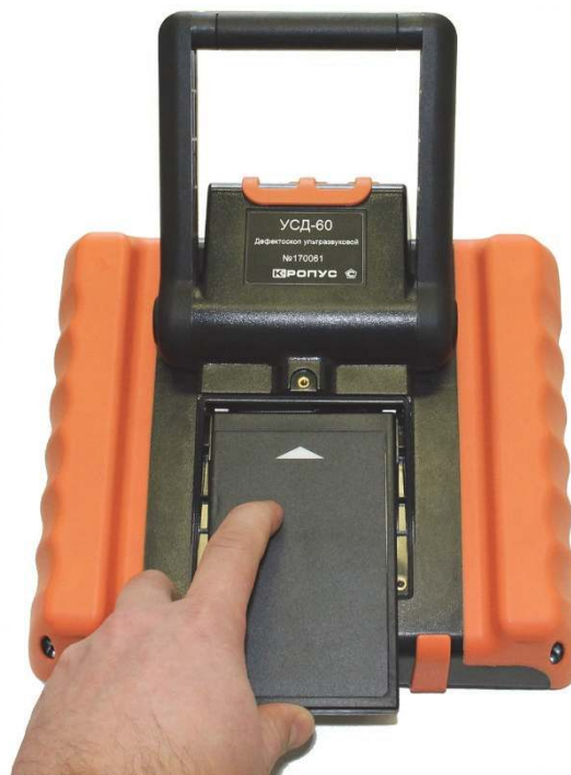
Рис.1-4 Установка нового аккумулятора
