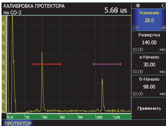
Рис.3-13 Калибровка наклонного преобразователя по образцу СО-3
