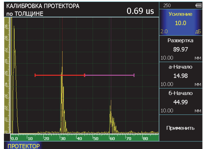
Рис.3-15 Экран калибровки прямого преобразователя по плоскопараллельному образцу толщиной 30мм
