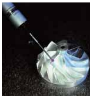
Высокоскоростной сканирующий датчик SP25
