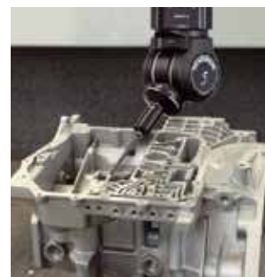
5-осевая измерительная система REVO
