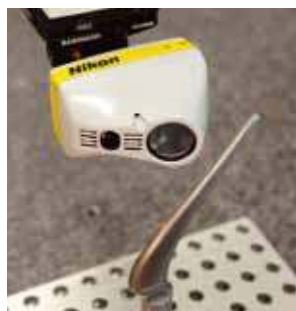
Высокоточный лазерный сканер LC15Dx
