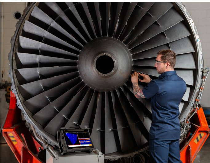
Рисунок 3: Проверка турбины с использованием Cypher, ПАУТ
