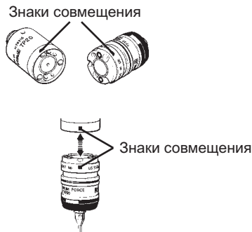
Рисунок 6 - Установка контактно-измерительного модуля со щупом в установочный модуль датчика
