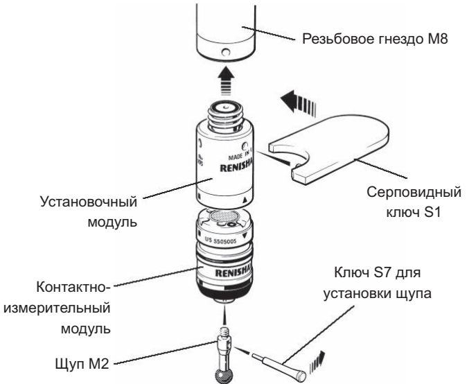
Рисунок 5 - Установка датчика TP20 в головку
